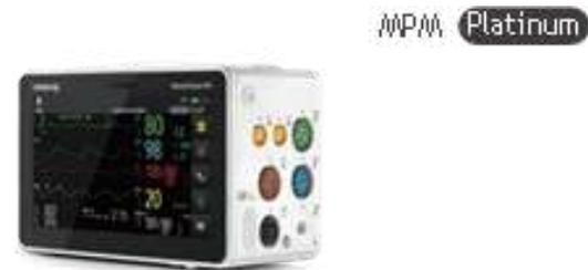
El módulo de CO2 de flujo lateral completamente integrado de N1 monitoriza la situación respiratoria de los pacientes mediante la conexión directa con la línea de muestreo. Por lo tanto, usted podría deshacerse de los grilletes de ampliación de los módulos externos para el transporte de pacientes, especialmente los que están intubados.
